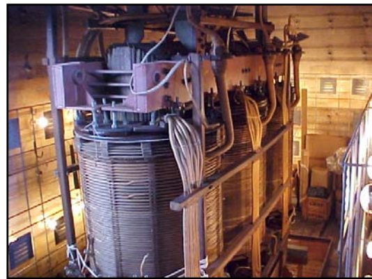
Fig. 7: Parte ativa do transformador de 12MVA 138/13,8kV na estufa de secagem.
