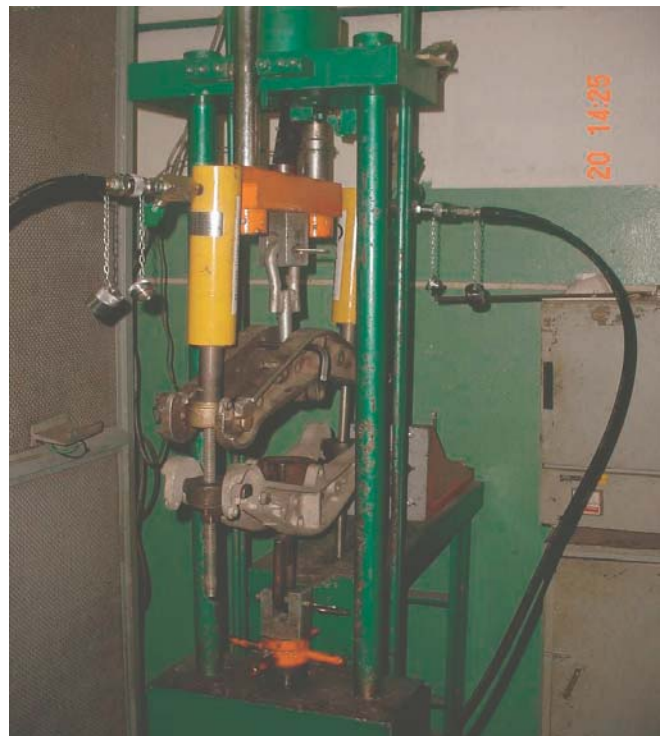
FOTO 02: Teste de sincronização dos cilindros
