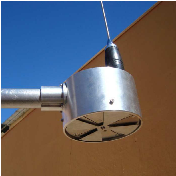
Figura 3 – Montagem final do receptor VLF e Field Mill.
