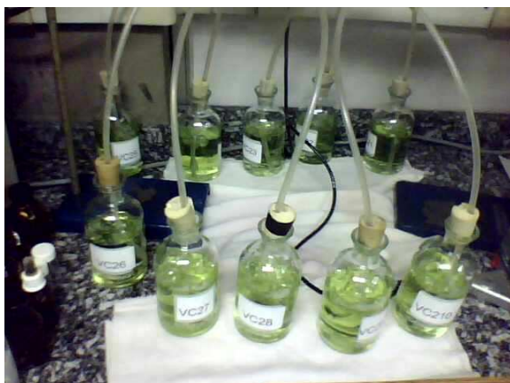
Figura 2. Borbulhamento de N 2 nas amostras de OVI.
