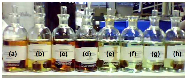
Figura 6. Amostras retiradas após 30 dias de envelhecimento, sendo: (a) PT-OMI a 100 o C; (b) PC-OMI a 100 o C; (c) PT-OMI a 125 o C; (d) PC-OMI a 125 o C; (e) PT-OVI a 75 o C; (f) PC-OVI a 75 o C; (g) PT-OVI a 100 o C e (h) PC-OVI a 100 o C.
