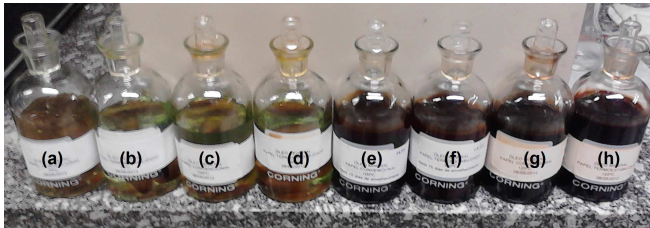
Figura 10. Amostras retiradas após 135 dias de envelhecimento, sendo: (a) PT-OVI a 75°C; (b) PC-OVI a 75°C; (c) PT-OVI a 100°C; (d) PC-OVI a 100°C; (e) PT-OMI a 100°C; (f) PC-OMI a 100°C; (g) PT-OMI a 125°C e (h) PC-OMI a 125°C.
