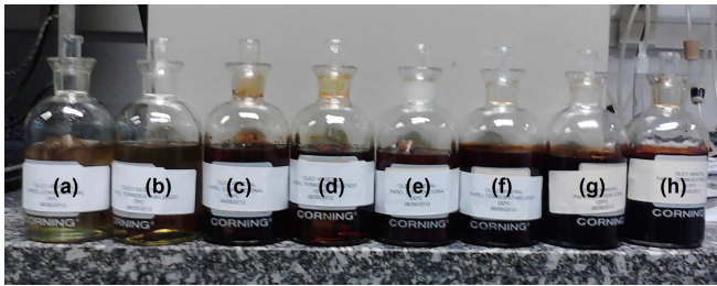
Figura 9. Amostras retiradas após 105 dias de envelhecimento, sendo: (a) PT-OVI a 75°C; (b) PC-OVI a 75°C; (c) PT-OVI a 100°C; (d) PC-OVI a 100°C; (e) PT-OMI a 100°C; (f) PC-OMI a 100°C; (g) PT-OMI a 125°C e (h) PC-OMI a 125°C.
