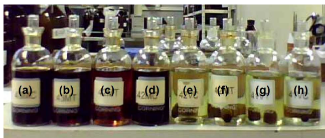
Figura 7. Amostras retiradas após 60 dias de envelhecimento, sendo: (a) PT-OMI a 125 o C; (b) PC-OMI a 125 o C; (c) PC-OMI a 100 o C; (d) PT-OMI a 100 o C; (e) PT-OVI a 100 o C; (f) PC-OVI a 100 o C; (g) PC-OVI a 75 o C e (h) PT-OVI a 75 o C.
