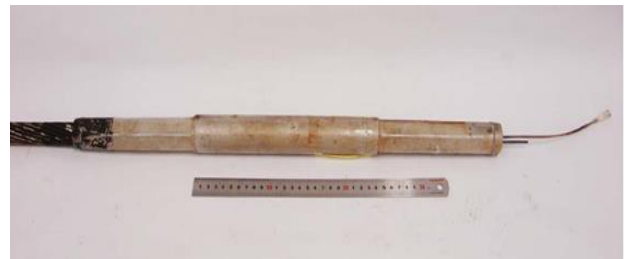
Figura 9 Cabo rompido em campo (emenda à compressão)
