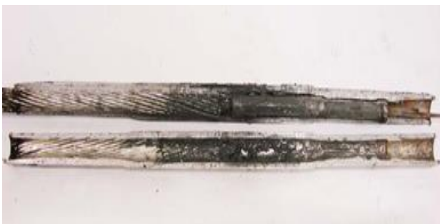
Figura 12 Corte da luva de alumínio para visualização e análise da qualidade
