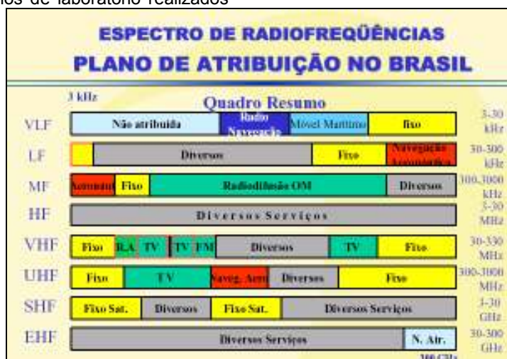
Figura 2 – Espectro de radiofrequências – plano de utilização no Brasil. Fonte http://www.anatel.gov.br/Tools/frame.asp?link=/biblioteca/releases/2003/anexo_release_05_05_2003.pdf
