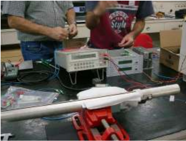
Figura 2- Instalação dos elementos sensores dentro do contato fixo da chave seccionadora.
