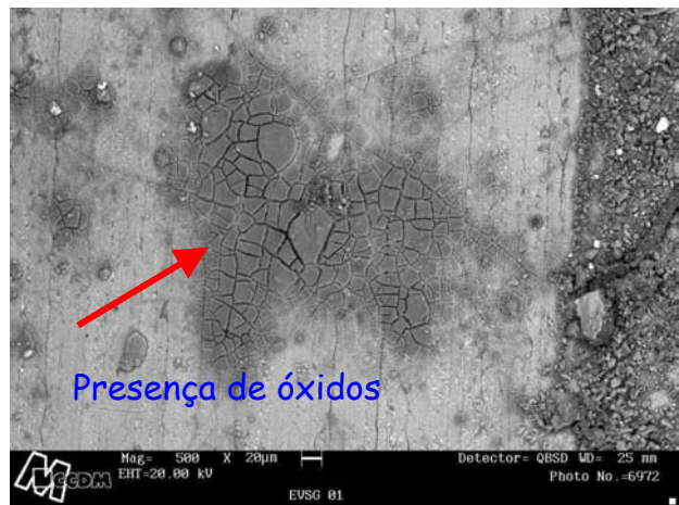
Figura 09 – Partícula abrasiva Al_2O_3 na superfície dos fios de alumínio.
