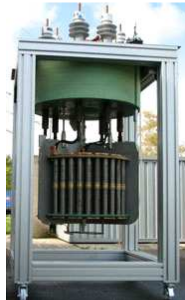
Fig. 11 – Limitador de curto supercondutor de 11 kV (projeto piloto da Nexans)
