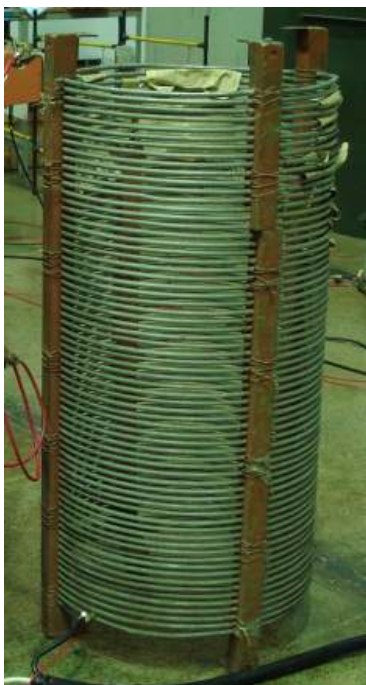
Figura 15 – Indutor utilizado na compensação reativa, valor nominal de 1mH e corrente nominal de 300A.
