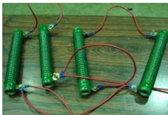
Figura 14 – Resistores utilizados na compensação reativa, com valor nominal 0,5 \Omega e potência nominal 200W cada.
