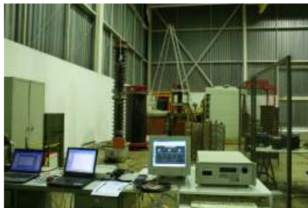
Figura 17 - Implementação do circuito de ensaio, com o analisador de QEE TOPAS 1000 à esquerda e fonte de tensão Califórnia 5001 iX à direita, em primeiro plano.
