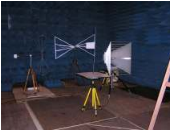
Figura 1: Antenas destinadas à recepção de sinais no interior da Câmara
